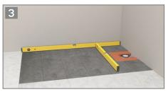
Para una correcta instalación la base sobre la que se va a colocar el plato de ducha debe estar PERFECTAMENTE NIVELADA y SECA ( se recomienda terrazo, mortero o similares). Se debe respetar el hueco de la válvula segun medidas tecnicas del plato de ducha a instalar. Conectar la válvula al tubo de PVC v comprobar que no hav fugas y que la válvula no sobresale de la superfie nivelada. Rellenar los huecos para que la válvula quede totalmente macizada.
