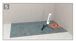
Aplicar sobre la base de terrazo o mortero una gran cantidad de masilla de poliuretano ( de tipo SIKAFLEX o POLIMERO MS )Aplicar dicha masilla tanto en la superficie como en las paredes de encuentro con el plato de ducha a instalar.
